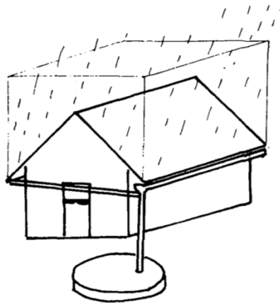
Figure 1: Schéma synthétique du système de récupération des eaux pluviales à partir des toits
