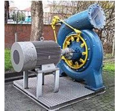
La technologie permet d'obtenir de l'énergie électrique à partir de la conversion de l'énergie hydraulique issue de flux ou de réserves d'eau : l'énergie cinétique du courant d'eau est transformée en énergie mécanique par une turbine, puis en énergie électrique par un alternateur. Les microcentrales ont pour objectif de pourvoir aux besoins locaux en énergie là généralement où la desserte n'est pas assurée par les services énergétiques de grande taille.
