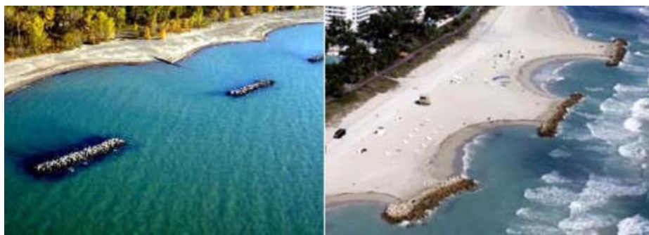
FIGURA 5: RESULTADO DE LA ACCIÓN DE GEOTUBOS SALIENTES (IZQUIERDA) Y TÓMBOLO (DERECHA)
