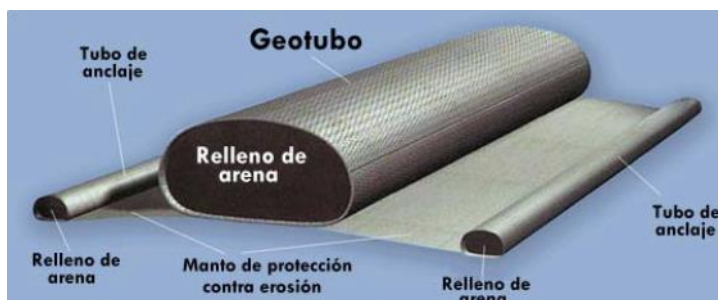
FIGURA 4: ESQUEMA DE UN GEOTUBO
