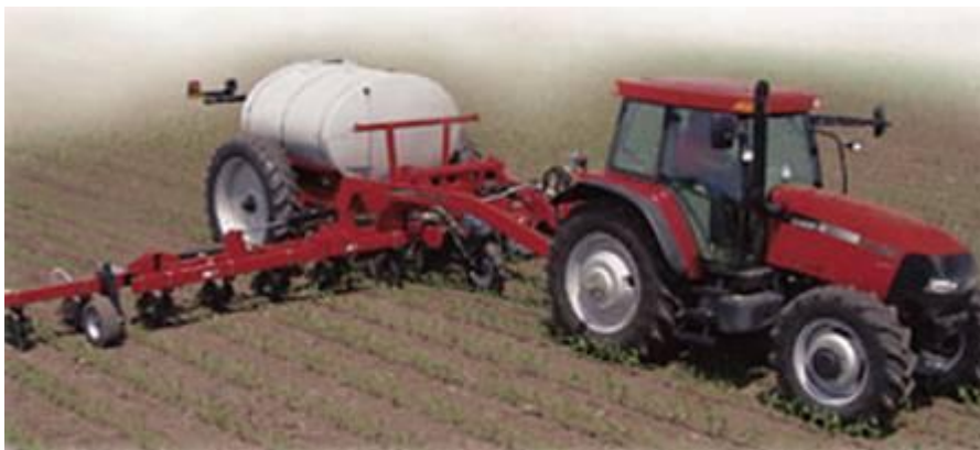
Figura 5.18. Incorporación de fertilizante entre surcos
