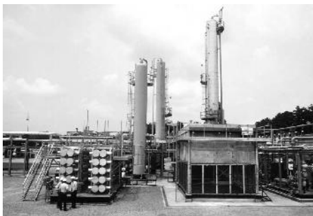
Figura 4.16. Comparación entre el uso del espacio para un sistema de adsorción por membranas (izq.) y un proceso absorción con aminas (resto de la imagen)
