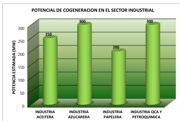
Figura 2.11. Potencial de cogeneración para subsectores industriales de envergadura sólo para sistemas de ciclo turbovapor
